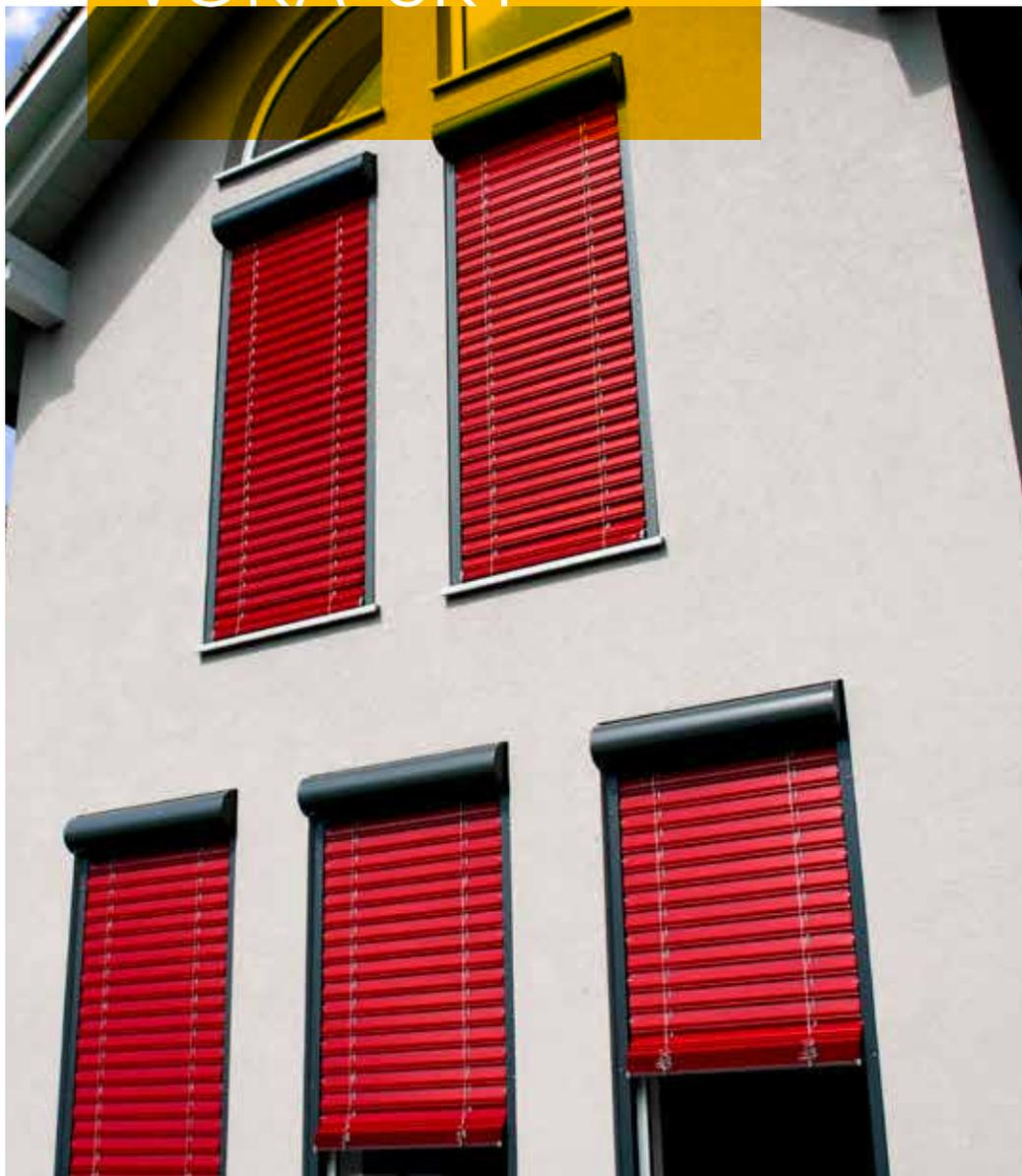
Vorgesetzter, stranggepresster Rollladenkasten mit Raffstore-Lamellenbehang. Das Modell ist in eckiger oder halbrunder Ausführung, optional auch als Unterputzvariante, erhältlich. Durch die integrierte Texbandumlenkung im Kasten benötigt der VOKA-SKY nur eine geringe Kastenhöhe.
